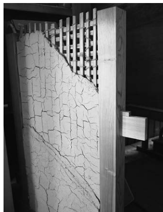
土壁の模型で施主に説明
